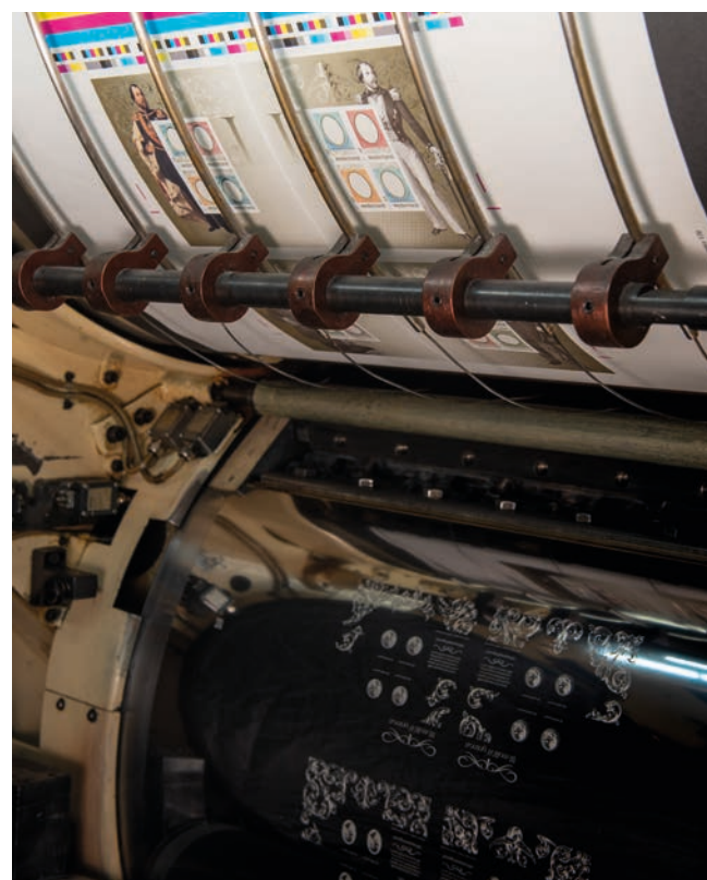
Foto rechts: De enige plaatdruckpers in Nederland. Dé druktechniek voor bankbiljetten en ander hoogwaardig beveiligd drukwerk, waar precisie, reliëf en kwaliteit samenkomen.
